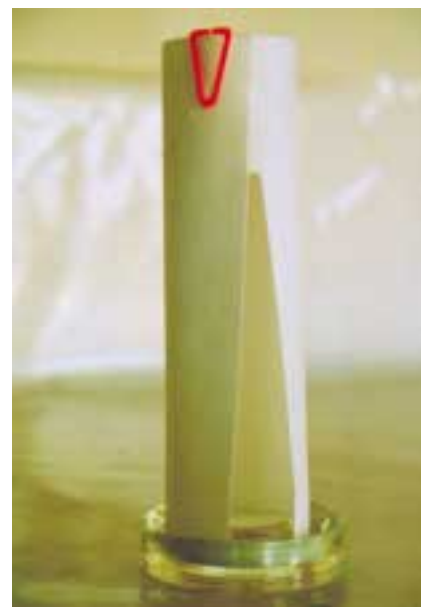
Figur 1: Stigbilledpapir i specialkonstrueret glasskål. Papiret er rullet sammen til en cylinder og holdes sammen for oven med en clips.
